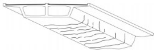
&lt; PSC 박스거더의 균열 &gt;
